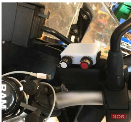
Trådløs kontroller montert på bremseveskeholderen. Føler denne nesten er et must.
